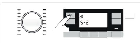
b) Appuyez à nouveau sur le bouton de « Réglage de la température » pour changer les niveaux de dosage de détergent liquide comme suit :
