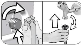
b) Serrez tous les écrous des tuyaux à la main. N'utilisez jamais un outil pour serrer ces écrous.
