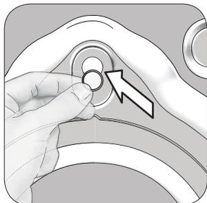
c) Après le retrait des boulons, fermez les trous avec des bouchons fournis dans le sachet contenant le manuel d'utilisation.
