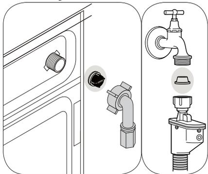
Un filtre se trouve à l'extrémité de chaque vanne d'arrivée d'eau, située au dos de la machine et à l'extrémité de chaque tuyau d'admission d'eau, où ils sont raccordés au robinet. Ces filtres empêchent les corps étrangers et la saleté qui se trouve dans l'eau de pénétrer dans le lave-linge. Les filtres doivent être nettoyés lorsqu'ils deviennent sales.
