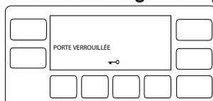
Un système de verrouillage a été prévu au niveau de la porte de la machine pour empêcher l'ouverture de la porte lorsque le niveau d'eau est inapproprié.
