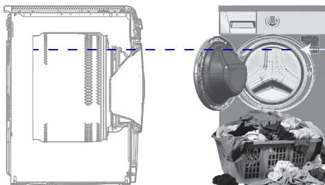
Pour le cycle 6 kg Lavage & 6 kg Séchage, nous vous conseillons de charger le linge dans l'appareil jusqu'au niveau spécifié dans la figure ci-dessus (le niveau de la flèche est indiqué sur la face intérieure de la porte de l'appareil) pour des conditions idéales de séchage.
