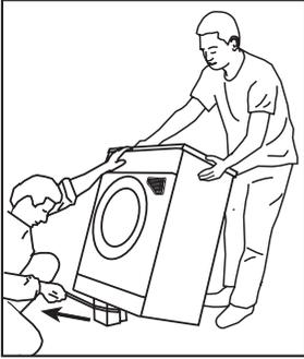
Inclinez la machine vers l'arrière pour retirer le renfort de conditionnement. Retirez le renfort de conditionnement en tirant sur le ruban.
