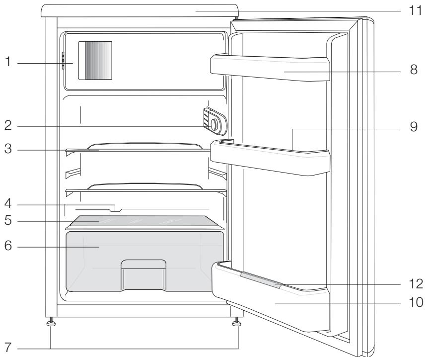
1. a.) Compartiment de congélation & bac à glaçons (pour les modèles **\*\***) b.) Compartiment pour denrées congelées & bac à glaçons (pour les modèles **\*\***)
