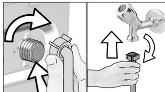
Ouvrez les robinets complètement après avoir raccordé les tuyaux pour vérifier si de l'eau ne fuit pas par les points de raccordement. Si vous constatez des fuites, fermez le robinet et retirez l'écrou. Resserrez l'écrou soigneusement après avoir vérifié le joint. Pour éviter toute fuite d'eau ou dégât consécutif, laissez les robinets fermés lorsque la machine n'est pas utilisée.
