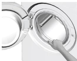
Si les orifices qui se trouvent sur le soufflet présenté dans le schéma ci-dessous sont obstrués, débloquez-les à l'aide d'un cure-dent.
