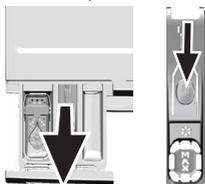
1. Appuyez sur le pointillé au-dessus du siphon dans le compartiment destiné à l'assouplissant, puis tirez vers vous jusqu'à ce que le compartiment soit enlevé de la machine.
