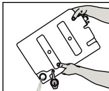
3. Si des peluches sont présentes sur l'entonnoir du réservoir d'eau, nettoyez-le sous l'eau courante.
