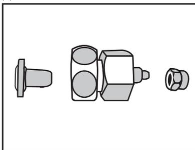
2. Raccordez l'adaptateur du robinet à la vanne d'arrêt du réseau d'approvisionnement d'eau.
