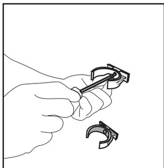
3. Fixez le filtre en position verticale sur les accessoires de raccordement, tel qu'illustré sur l'étiquette. ( 6 ).
