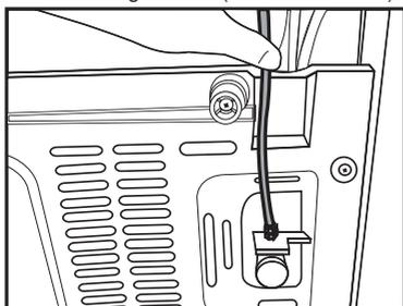
Une fois le raccordement effectué, l'installation devrait être semblable à l'image ci-dessous.
