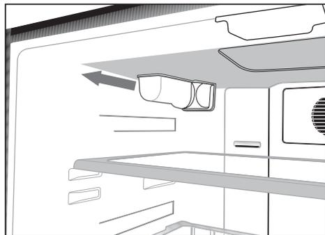
3. Placez le couvercle du filtre dans le mécanisme et poussez-le pour verrouiller.
