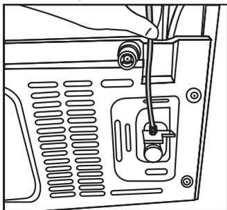
3. Serrez le joint à la main pour fixer l'adaptateur de l'embout du tuyau. Vous pouvez également serrer le joint avec une clé serre-tube ou des pinces.
