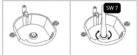
5. Si votre produit est équipé d'une chambre de combustion pour wok avec un injecteur à entrée latérale, retirez l'injecteur avec une clé numéro 7.
