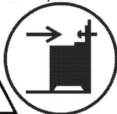
**Avertissement :** Ce système de stabilisation doit être installé pour empêcher l'appareil de basculer. Consultez les instructions pour l'installation.
