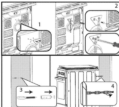
**i** La chaîne de sécurité doit être aussi courte que possible afin d'éviter que le piano de cuisson ne bascule vers l'avant et, en diagonale afin d'éviter que le piano de cuisson ne s'incline sur le côté. La chaîne de stabilité de la cuisinière conçue pour les plaques de cuisson, n'est pas fournie avec une encoche comme support.
