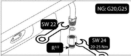
6. Enroulez un produit d'étanchéité autour de la partie filetée de l'interconnecteur. Raccordez la partie filetée du tuyau/tuyau de gaz de sécurité à l'interconnecteur à l'aide de la clé de 24 mm et serrez fermement, en maintenant l'interconnecteur en place avec la clé de 24 mm.
