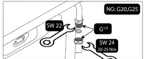
3. Vous devez vérifier l'étanchéité de la pièce de raccordement après le raccordement.
