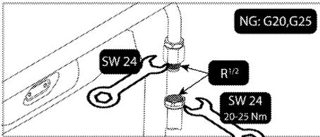
7. Vous devez vérifier l'étanchéité de la pièce de raccordement après le raccordement.
