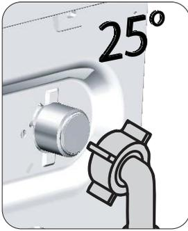
a) Connectez l'extrémité tendue du tuyau d'arrivée du réseau fourni avec la machine au robinet d'eau froide et l'extrémité tordue à l'arrivée d'eau située à l'arrière de la machine tel qu'indiqué dans le schéma.
