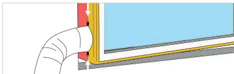
**5.** Ouvrez la fenêtre délicatement et ouvrez la fermeture à glissière de la pièce en tissu (au niveau du bas ou du milieu de la fenêtre) puis introduisez la gaine d'évacuation dans l'ouverture. Réajustez la fermeture à glissière afin que la gaine d'évacuation soit fixée pour ne pas avoir d'échange d'air entre l'intérieur et l'extérieur.
