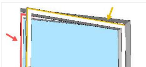
**2.** Découpez des grandes bandes de ruban agrippant adhésif aux dimensions de la fenêtre. Collez-les sur le cadre de votre fenêtre puis faites la même chose sur la surface intérieure du battant de la fenêtre (du côté de la poignée).
