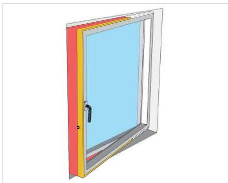
**3.** Collez le côté le plus large (A) de la grande pièce en tissu blanc sur le cadre de la fenêtre puis collez le côté le plus étroit (B) sur le battant de la fenêtre (côté de la poignée) en partant du centre, puis vers le haut et enfin vers le bas.
