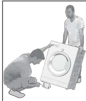
Inclinez la machine vers l'arrière pour retirer le renfort de conditionnement. Retirez le renfort de support d'emballage fixé sur le ruban.
