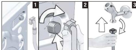
1. Raccordez le tuyau spécial fourni avec la machine aux vannes d'arrivée d'eau de la machine
