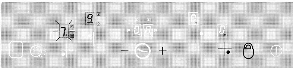
"**0**" cette touche vous permet de verrouiller/déverrouiller la commande tactile en mode de fonctionnement.
