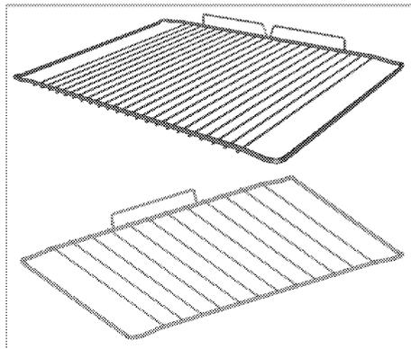
**4. Правильное расположение проволочной решетки на выдвижных направляющих (Данная функция — дополнительная. Она может отсутствовать в вашем изделии.)**
