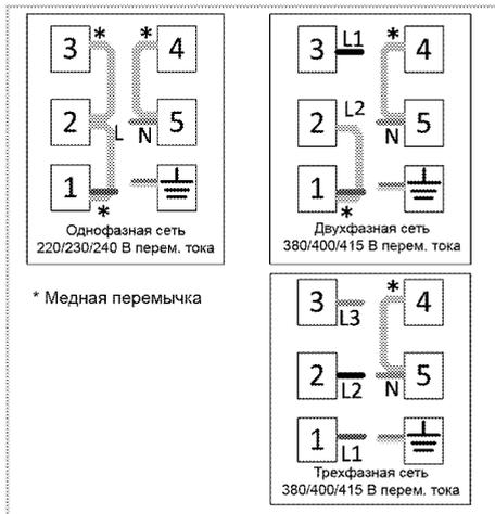
**2. Инструкция по подключению к однофазной электрической сети.**
