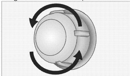
3. Si la lampe de votre four est de type (A) comme l'indique le schéma ci-après, ôtez-la en la faisant pivoter comme illustré, avant de la remplacer. Si, par contre, elle est de type (B), tirez-la pour l'ôter comme illustré sur le schéma avant de la remplacer.
