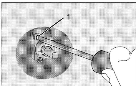
5. Отрегулируйте высоту пламени горелки духовки до 2-3 мм с помощью винта 1 на газовом кране духовки. Чтобы увеличить пламя, поверните винт по часовой стрелке, чтобы уменьшить – против часовой стрелки.
