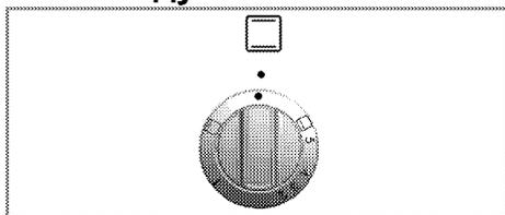
Для управления газовой духовкой используется ручка регулятора газовой горелки. При положении "Выключено" (вверх) подача газа прекращается.
