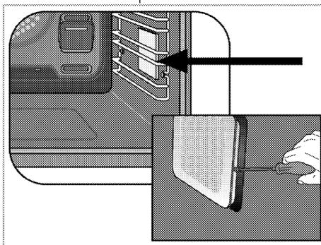
3. Soulevez le couvercle de protection en verre de la lampe à l'aide d'un tournevis.
