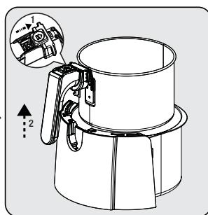
Para liberar la cesta desde el cajón, coloque el cajón en una superficie plana. Desplace la cubierta de protección (3), pulse el botón de liberación de la cesta (4) y eleve la cesta del cajón y extráigala.
