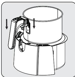
Hay 2 muescas a ambos lados del mango. Fije la cesta en el cajón deslizando las lengüetas en las muescas de la parte superior del cajón de la cesta.
