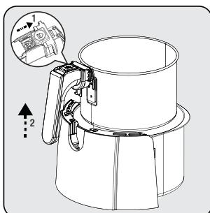
Drücken Sie die Korbentriegelungstaste (4), heben Sie den Griff (5) an und ziehen Sie ihn nach oben, um den herausnehmbaren Garkorb (7) herauszunehmen.
