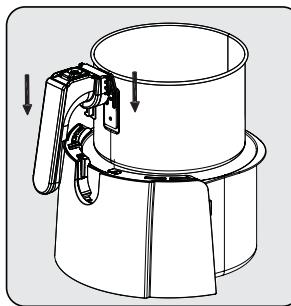
Po obu stronach uchwytu znajdują się 2 wycięcia. Koszyk należy zablokować w szufladzie, wsuwając wypustki w wycięcia w górnej części szuflady.
