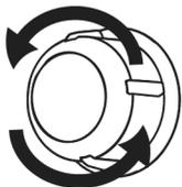
3. Si la lampe du four est de type (A) illustré dans la figure ci-dessous, tournez la lampe du four comme indiqué dans la figure et remplacez-la par une nouvelle. S'il s'agit d'un modèle de type (B), retirez-le comme indiqué sur la figure et remplacez-le par un nouveau.
