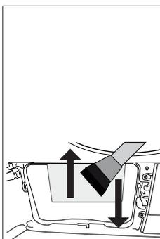
Les peluches collectées sur la surface du condenseur doivent être enlevées avec un chiffon humide ou en frottant la brosse placée sur le couvercle d'acheminement de l'air de haut en bas sur le condenseur. Veuillez ne pas nettoyer les ailettes du condenseur dans le sens droite-gauche pour éviter tout dommage. Vous pouvez également utiliser un aspirateur avec une brosse pour le nettoyage. Le nettoyage du condenseur n'est pas recommandé avec un aspirateur sans brosse.
