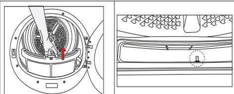
Votre machine est équipée de capteurs d'humidité qui détectent si le linge est sec ou non. Pour nettoyer le capteur :
