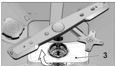
3. Pressez les deux cliquets du gros filtre vers l'intérieur et séparez le gros filtre de l'assemblage.
