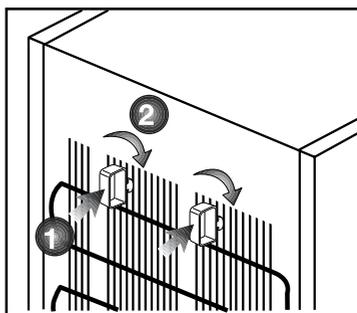
permettre une bonne circulation de l'air. (Le schéma présenté est fourni à titre indicatif et peut ne pas correspondre exactement avec votre produit.)
