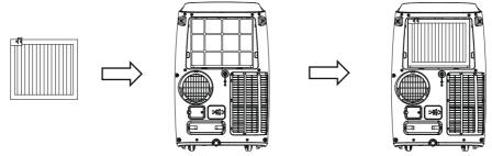
3. Remettez le filtre à air de l'appareil.
