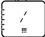
Cette fonction permet au four de s'autonettoyer à une température élevée. Elle est recommandée pour les fours légèrement sales. Lisez la description contenue dans la section relative au nettoyage pour utiliser cette fonction. Voir *page 31*.
