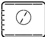
Les éléments chauffants supérieur, inférieur et celui avec ventilateur sont en marche. La nourriture est cuite également sur tous les côtés et rapidement. Cuisson avec une seule plaque.
