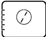
L'air chaud généré par la résistance arrière est réparti rapidement et de façon uniforme dans le four à l'aide du ventilateur. Cela permet de cuire des plats sur différents châssis et le préchauffage n'est pas nécessaire dans la plupart des cas. Adapté pour la cuisson avec des plaques multiples.
