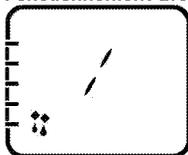
Le four n'est pas chauffé. Seul le ventilateur (dans la paroi arrière) est en marche. Adapté pour décongeler les aliments granulaires surgelés lentement à température ambiante et refroidir les aliments cuisinés.
