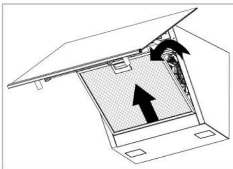
3. Réinstallez le filtre en aluminium dans son emplacement après le rinçage en suivant les étapes ci-dessus en sens inverse.
