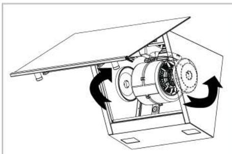
3. Placez les encoches de vos nouveaux filtres à charbon dans les encoches du support du moteur et tournez-les dans le sens des aiguilles d'une montre pour les mettre en place.
