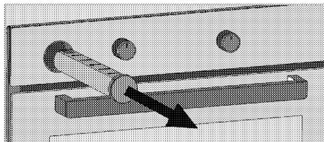
5. Ouvrez le couvercle du réservoir d'eau et remplissez-le d'eau conformément à la quantité indiquée dans le tableau de cuisson.
