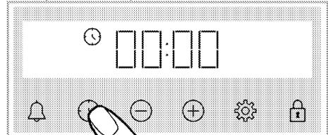
**i** Une fois la fonction et la température réglées, vous pouvez régler le temps de cuisson pour 30 minutes en appuyant directement sur la touche ⊕ pour un réglage rapide du temps de cuisson et modifier le temps à l'aide des touches ⊕/⊖.
