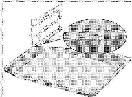
**Mise en place appropriée de la grille métallique et du plateau sur les rails télescopiques Modèles à étagères grillagées et rails télescopiques**
