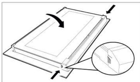
2. Tirez vers vous le composant en plastique fixé sur la partie supérieure de la porte avant en poussant simultanément sur les points de pression des deux côtés du composant et retirez-le.
