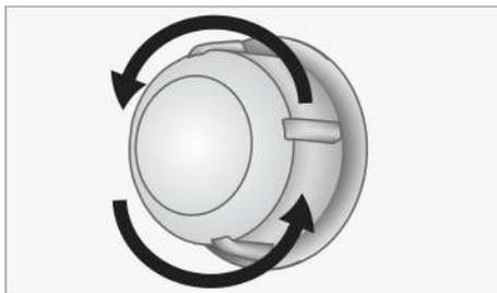
3. Si la lampe du four est de type (A) illustré dans la figure ci-dessous, tournez la lampe du four comme indiqué dans la figure et remplacez-la par une nouvelle.
