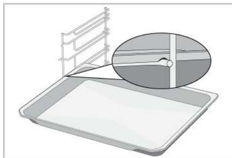
**Mise en place appropriée de la grille métallique et du plateau sur les rails télescopiques**
