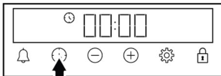
**i** Pour régler rapidement le temps de cuisson, vous pouvez directement toucher la **+** pour régler le temps de cuisson à 30 minutes après avoir réglé la fonction de fonctionnement et la température puis utiliser les touches **+**/**-** pour modifier l'heure.
