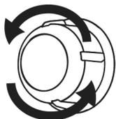
3. Si la lampe du four est de type (A) illustré dans la figure ci-dessous, tournez la lampe du four comme indiqué dans la figure et remplacez-la par une nouvelle. S'il s'agit d'un modèle de type (B), retirez-le comme indiqué sur la figure et remplacez-le par un nouveau.
