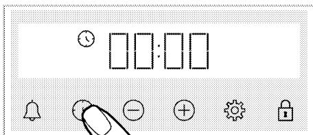
**i** Une fois la fonction et la température réglées, vous pouvez régler le temps de cuisson pour 30 minutes en appuyant directement sur la touche  $\oplus$  pour un réglage rapide du temps de cuisson et modifier le temps à l'aide des touches  $\oplus/\ominus$ .
