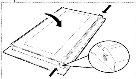
2.Trek aan het plastic onderdeel, bevestigd op de bovenste sectie van de deur vooraan, naar u toe door tegelijkertijd druk uit te oefenen op de drukpunten aan beide zijden van het onderdeel en verwijder het.
