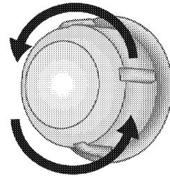
3. Als uw ovenlamp van type (A) is zoals weergegeven in de onderstaande afbeelding moet u de ovenlamp draaien zoals aangetoond in de afbeelding en ze vervangen met een nieuwe lamp. Als type (B) een model is, moet u ze verwijderen zoals aangetoond in de afbeelding en ze vervangen met een nieuwe lamp.
